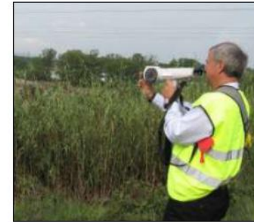
Photographie 2 : Mesure de la concentration d'odeurs à proximité d'un site industriel
